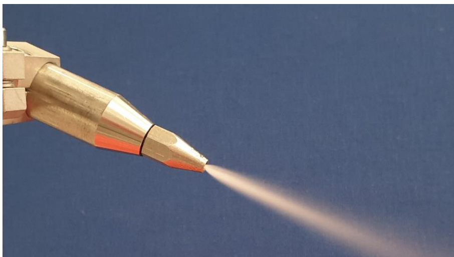
Obr. 3: Koaxiální tryska v průběhu generování dvoufázového spreje
