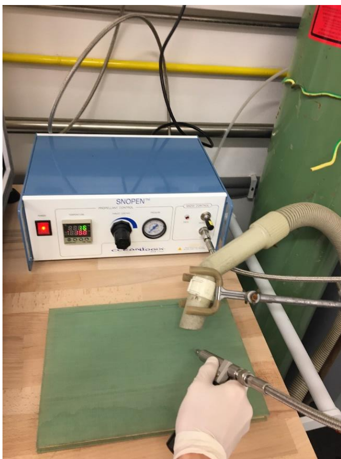
Obr. 6: Příklad čištění knihovních materiálů pomocí dvoufázového spreje v nejjednodušším uspořádání
