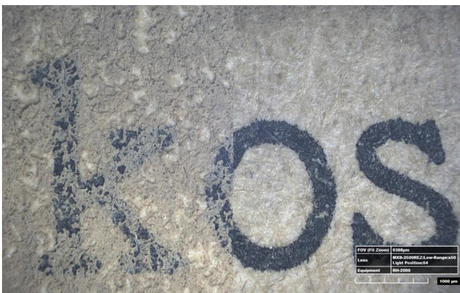
Obr. 29: Elektrické gumovadlo (Ecobra, eraser refills 3921 ivory): vlevo před čištěním, vpravo po čištění
