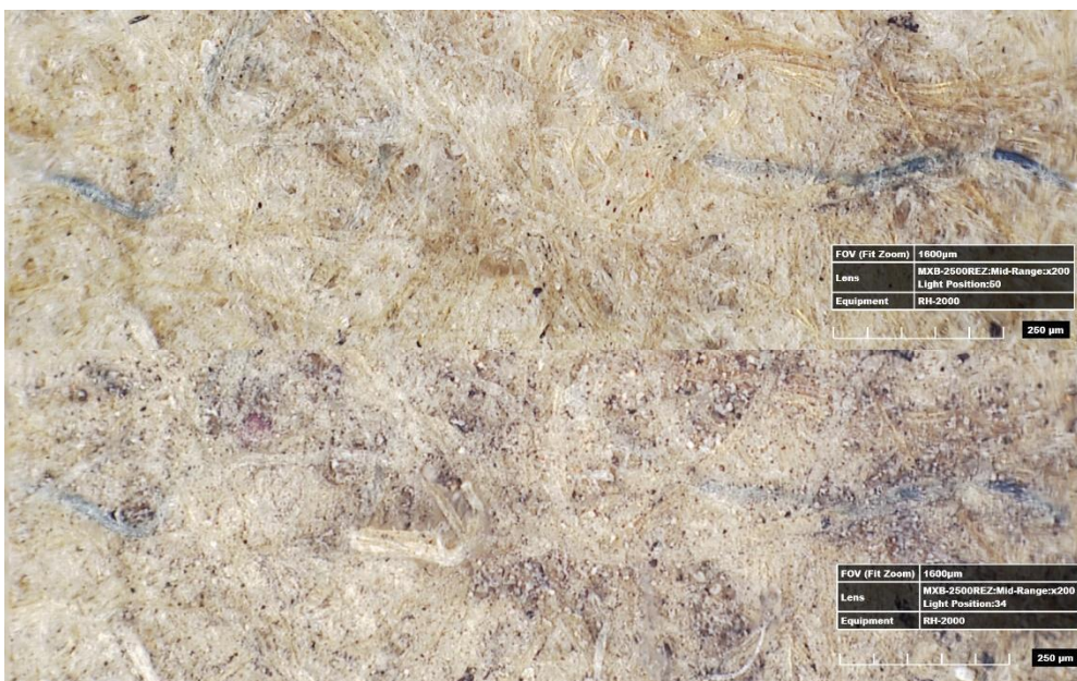
Obr. 17: Sypké čisticí (AKA Wipe powder white): dole před čištěním, nahoře po čištění
