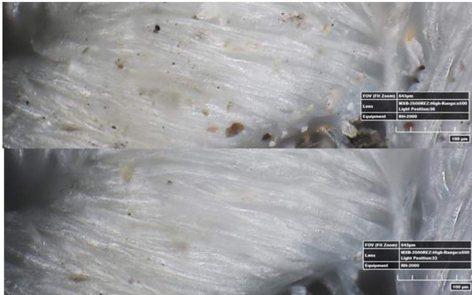
Obr. 19: 3D optická mikroskopie – nahoře před čištěním a dole po čištění pomocí proudu N 2
