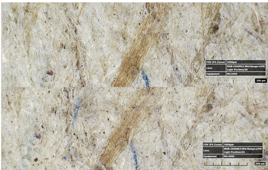
Obr. 13: Pryžový blok (Wishab): dole před čištěním, nahoře po čištění
