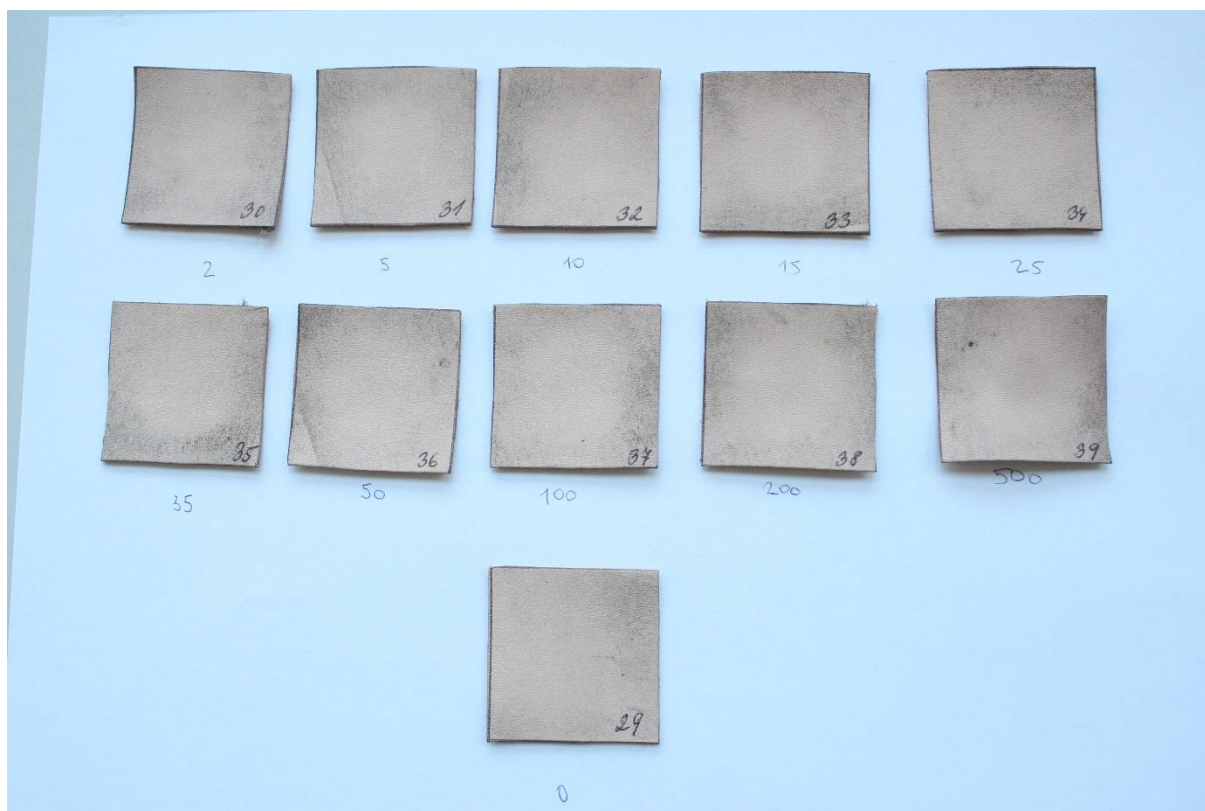
Obr. 3: Ilustrační fotografie usně teletiny a částicemi slonovinové černi před čištěním (0) a po čištění 2, 5, 10, 15, 25, 35, 50, 100, 200 a 500 pulzy (označení číslicí pod vzorkem odpovídá použitému počtu pulzů)
