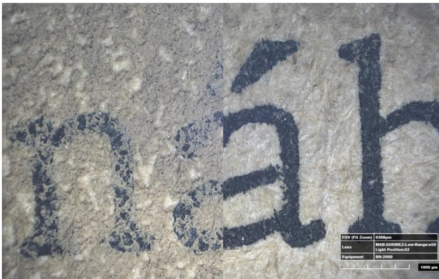
Obr. 27: Pevný PVC blok (Faber-Castell): vlevo před čištěním, vpravo po čištění.
