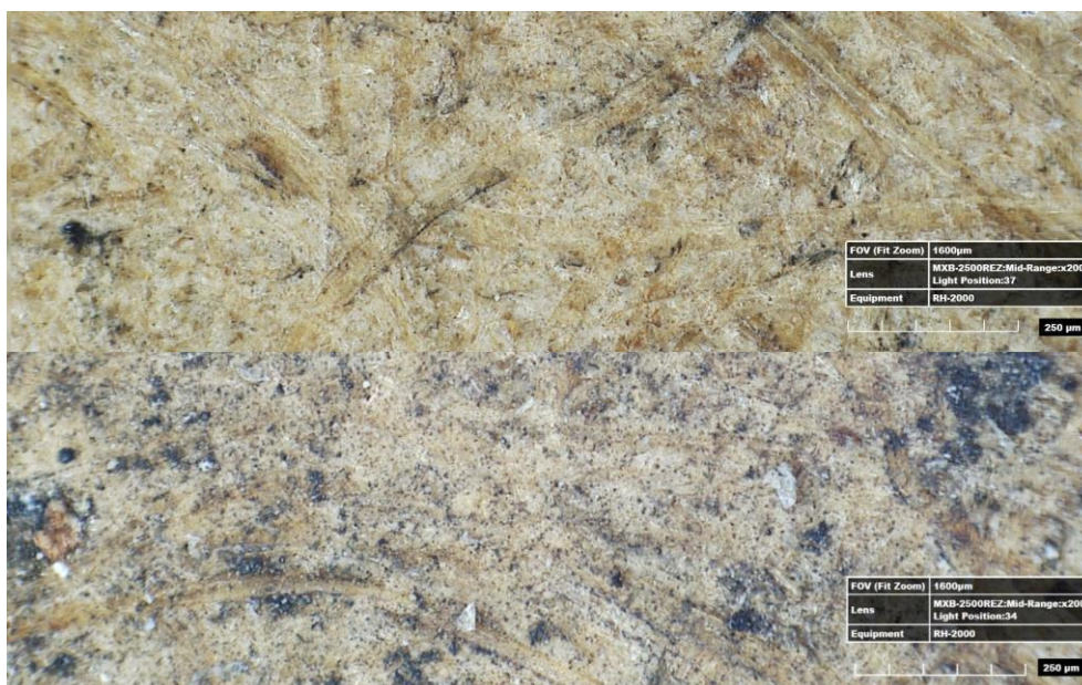
Obr. 3: CO 2 dvoufázový sprej dole před čištěním, nahoře po čištění
