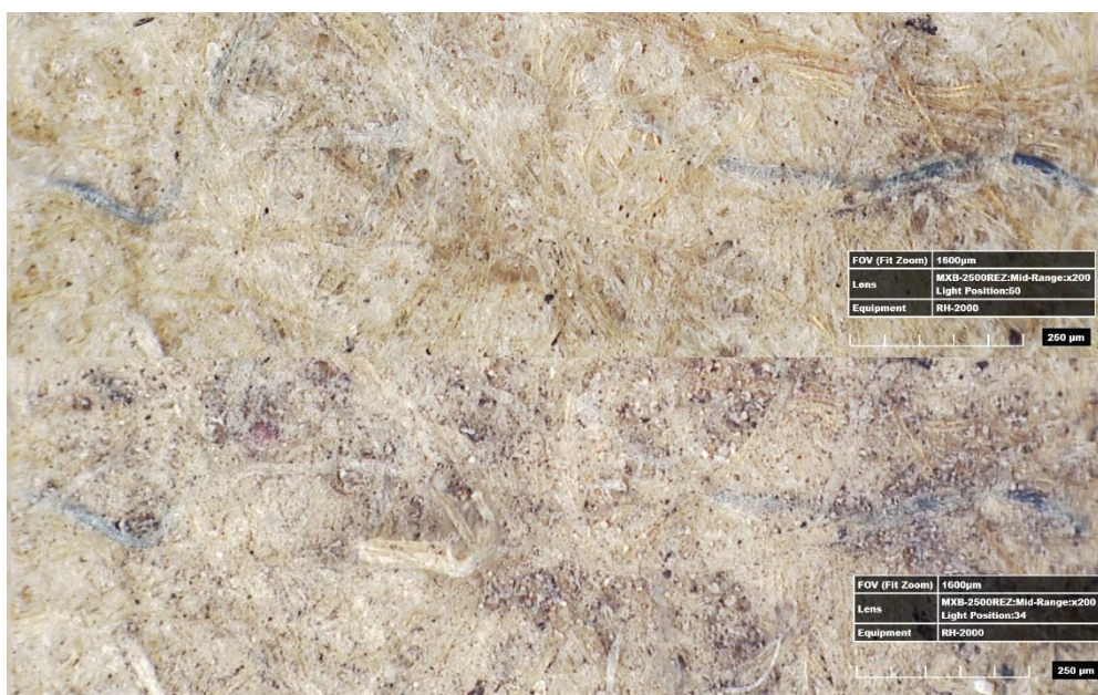
Obr. 12: Sypké čisticí (AKA Wipe powder white): dole před čištěním, nahoře po čištění
