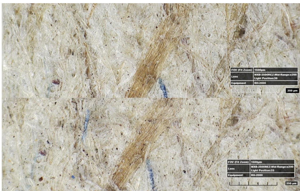
Obr. 8: Pryžový blok (Wishab): dole před čištěním, nahoře po čištění
