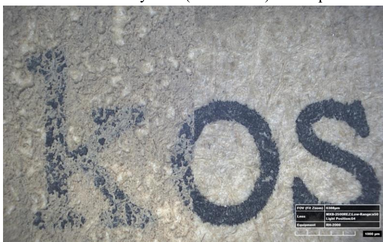
Obrázek 24: Elektrické gumovadlo (Ecobra, eraser refills 3921 ivory): vlevo před čištěním, vpravo po čištění.
